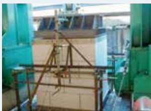
【EPS開発機構・JSP】 交通荷重想定鉛直振動実験
