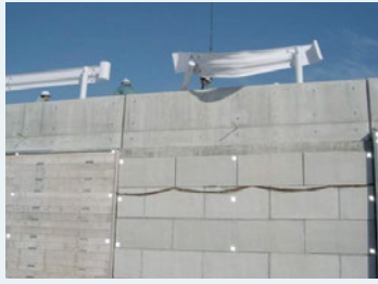
【(独)北海道開発土木研究所・ 発泡スチロール土木工法開発機構】 1年間常時微動観測、交通荷重載荷実験、 ガードレール衝突実験など
