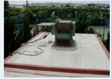
【発泡スチロール土木工法開発機構・JSP】 レベル2地震想定振動実験
